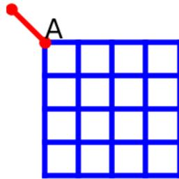
25 maisons sont positionnées aux 25 intersections du quadrillage ci-dessus. Le courant (rouge) arrive à un angle du carré (point A). Il faut relier chaque maison au courant pour un coût minimal. Pour cela il faut tirer un câble entre le point A et chaque intersection. Les câbles ne peuvent passer que par les routes (les lignes du quadrillage), pas de diagonales donc.
