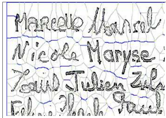
Fig. 3.5: Diagramme de Voronoï utilisé pour une segmentation en lignes : le résultat laisse apparaître des lignes en pointillé. Dans 95% des cas, les segments de Voronoï sont bien classés.
