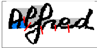
Fig. 3.32: Segmentation à partir de réservoirs d'eau ([Pal2003]) : les vallées et les collines sont en quelque sorte remplies d'eau, si elles sont suffisamment profondes ou hautes, elles marquent la séparation entre deux caractères.
