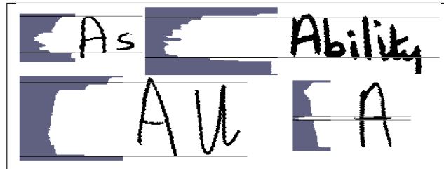
Fig. 3.19: Mauvais positionnement des lignes d'appui : les mots sont trop courts ou incluent des minuscules décorées comme la lettre "i". Ces cas sont minoritaires.
