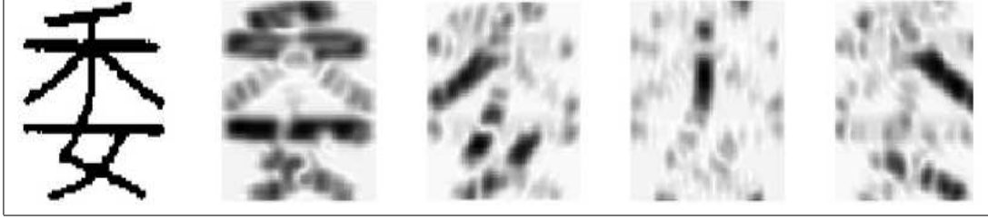
Fig. B.19: Réponses des quatre filtres de Gabor correspondant aux quatre directions, 0^\circ , 45^\circ , 90^\circ , 135^\circ , figure extraite de [Su2003].
