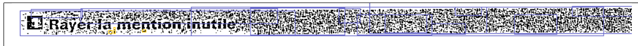
Fig. N.13: Sans traitement spécifique, ce bruit gêne la formation d'une ligne car les pixels se touchent et forment une seule composante connexe. Une solution envisageable serait de compter le nombre de transitions pixels noir/blanc pour dissocier la zone de texte de la zone de bruit.
