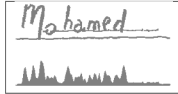
Fig. 3.36: Sélection des zones de coupures entre graphèmes : problème des mots soulignés, l'histogramme représenté correspond à une projection verticale lissée par une moyenne mobile uniforme d'ordre trois.
