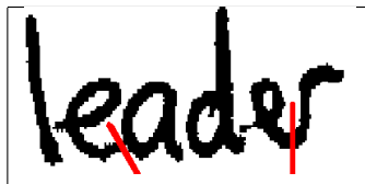
Fig. 3.33: Segmentation à partir de réservoirs d'eau ([Pal2003]) : deux points de coupures différents, le premier est situé au fond d'une vallée à droite sur un embranchement, le second est situé dans un creux, au milieu d'une courbe en "u". La coupure ne doit donc pas toujours intervenir à l'endroit du minimum local.
