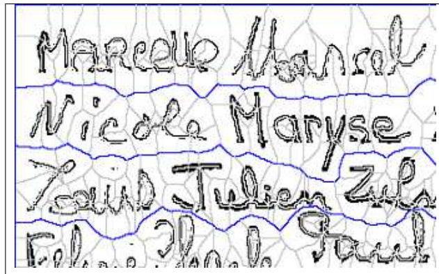
Fig. B.32: Appariement : les frontières (gris pâle et foncé) délimitent les zones de pixels (noirs) apparifiés au même morceau du squelette.
